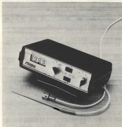
Termometro digitale a due sonde con 0,1° di risoluzione
