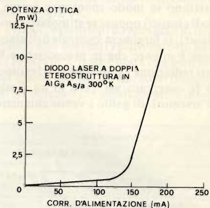
Fig. 13-a - Caratteristica del diodo laser che permette di modulare il fascio ottico.
